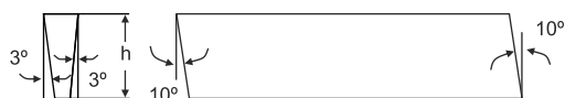
Lâminas Forma "E" - DIN4964 - H8 10° CO Outil de tour forme "E" - DIN4964 - H8 10° CO
